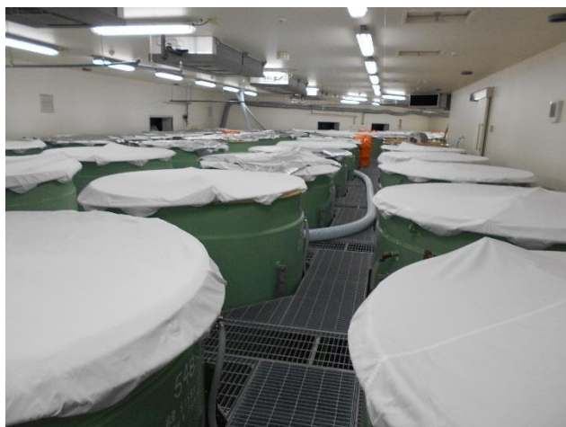
酒を醗酵させているタンクが所狭しと並べられている工場内部
